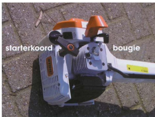
Figuur 4.15 Bij een bosmaaier moet je ook het starterkoord en de bougie controleren.
