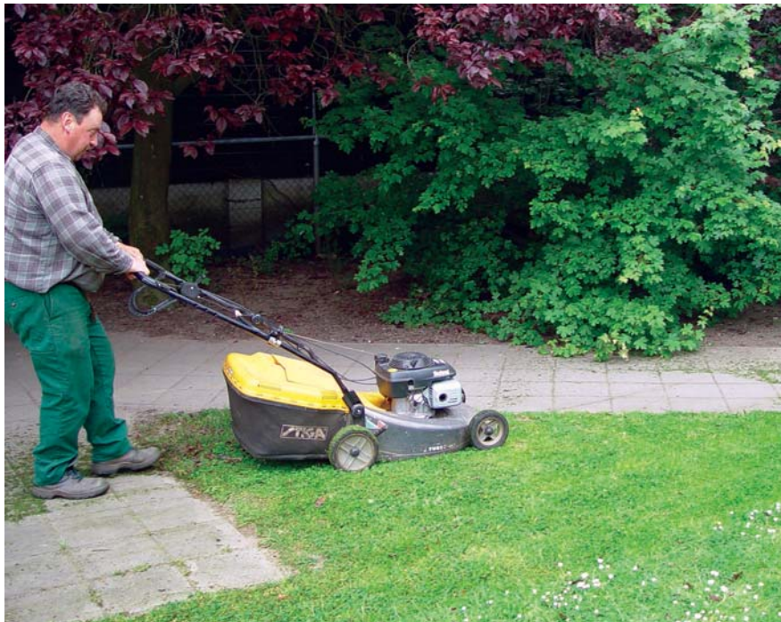
Figuur 4.16 Een cirkelmaaier met opvangbak
